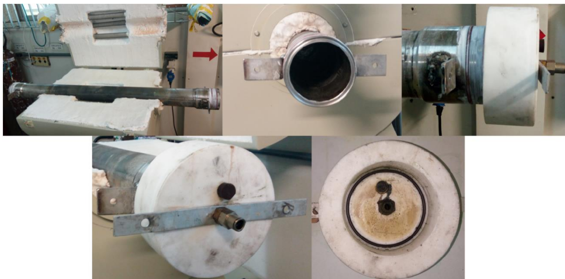
Figura 9- Imagens do forno tubular da marca Jung com o tubo de aço inox acoplado com o flange de teflon.
