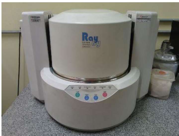
Figura 16- Equipamento para análise de FRX, modelo EDX 700, marca Shimadzu.
