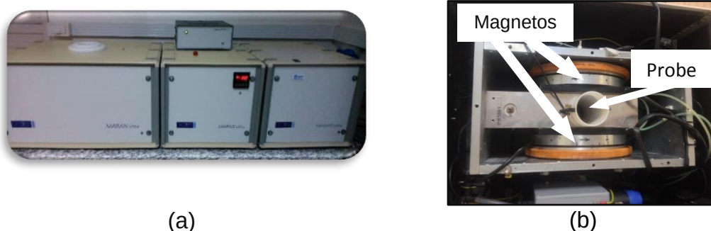
Figura 16: Imagem do espectrômetro de RMN (na foto do interior do RMN (b), podem-se observar a posição das duas placas do ímã que produzem o campo magnético ( B_0 ) e a posição do probe , onde as amostras são inseridas para a realização das análises.
