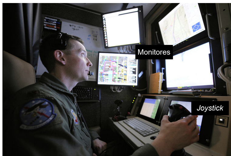
Figura 2.3: Cockpit para teleoperação remota de drones. O operador gerencia dados de múltiplas fontes enquanto opera o sistema. Adaptado de Rea e Seo [3].
