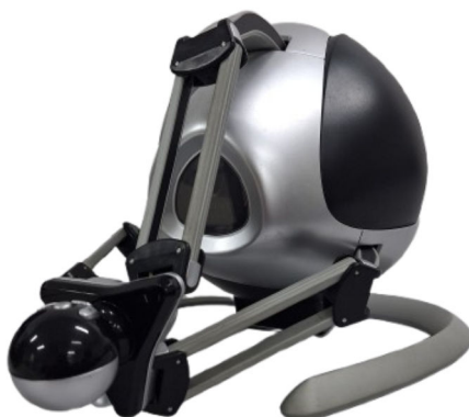
Figura 3.10: Dispositivo háptico Novint Falcon, com 3 graus de liberdade para feedback de força e medição de posição, empregado na interação com o sistema robótico.
