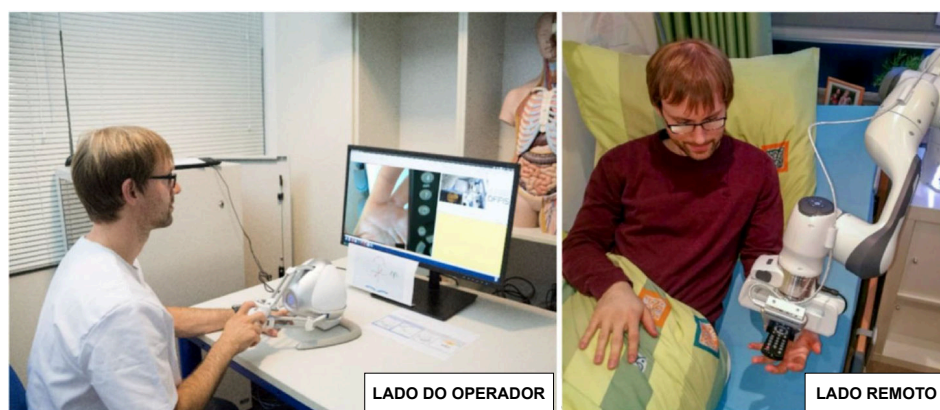
Figura 2.9: Exemplo de uma estação de teleoperação utilizando um dispositivo háptico (Novint Falcon) como interface de controle e um monitor 2D para feedback visual. Adaptado de Gliesche et al. [28].
