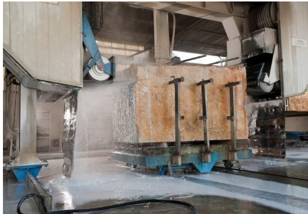
Figura 5 – Corte do bloco de granito utilizando água
