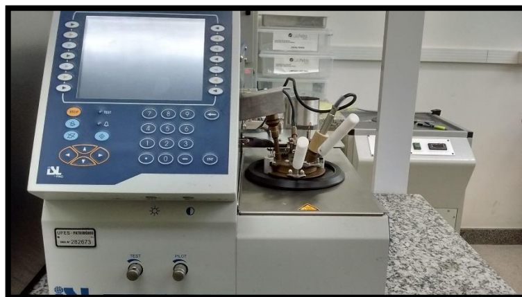
Figura 3.6 Equipamento para ensaio de Ponto de fulgor. Fonte: Laboratório de Núcleo de Competências em Químicas do Petróleo – LabPetro/UFES.
