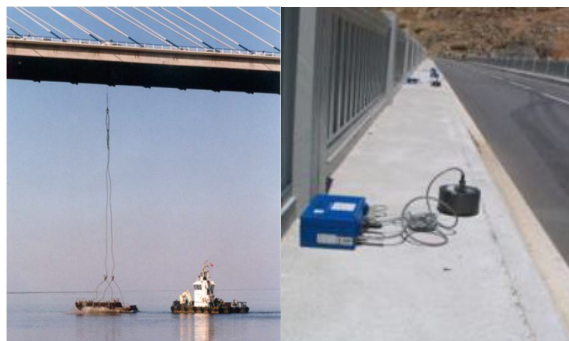
Figura 5 – Ensaio de vibração livre a esquerda e vibração ambiental a direita (Fonte: Tavares (2013))
