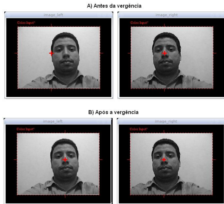
Figura 4-7 – Imagens (320x240) direita e esquerda de uma mesma cena. A cruz vermelha indica a posição para onde o olho está olhando, ou seja, o ponto da imagem projetado diretamente na fóvea. (A) Ao escolher um ponto na imagem direita, coordenada [132,135], o olho esquerdo se move para a posição correspondente, coordenada [189,135], fazendo com que o observador esteja "olhando para o infinito". (B) Após o processo de vergência os dois olhos estão orientados de forma que o ponto escolhido esteja sendo projetado diretamente na fóvea de cada retina. O olho direito continua na coordenada [132,135], enquanto que o olho esquerdo moveu para a coordenada [189,135] que é o ponto correspondente ao ponto focalizado pelo olho direito [132,135].
