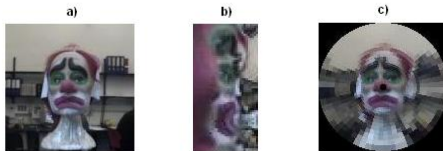
Figura 3-4 - Exemplo da aplicação da transformação log-polar. Fonte: http://omni.isr.ist.utl.pt/~alex/Projects/TemplateTracking/logpolar.htm . Acesso em: 22 dez. 2004.
