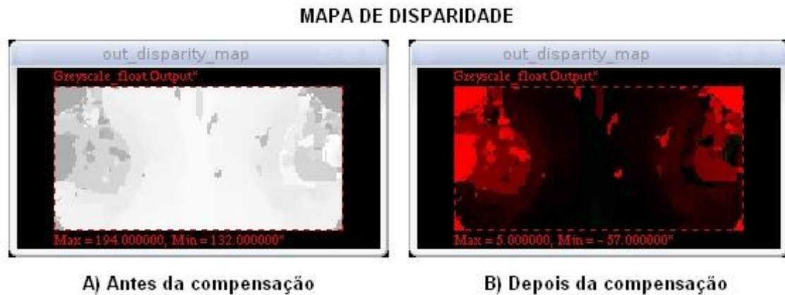
Figura 4-10 - Figura mostrando a compensação feita no mapa de disparidade após a vergência. (A) Antes da vergência, o mapa possui as disparidades associadas as coordenadas de cada uma das 64 camadas de MT, que neste caso variam de 132 à 194. (B) A vergência (neste caso) foi escolhida pela camada de coordenada 189, portanto, todo o mapa foi compensado, subtraindo a coordenada de vergência, onde a disparidade deve ser igual a zero, tendo então disparidades variando de -57 à +5.
