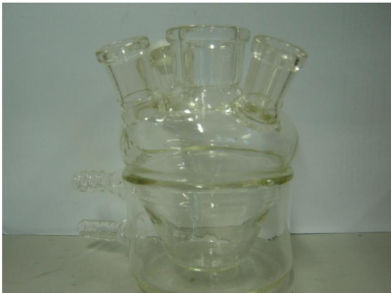
Figura 15: Célula eletroquímica utilizada para os experimentos
