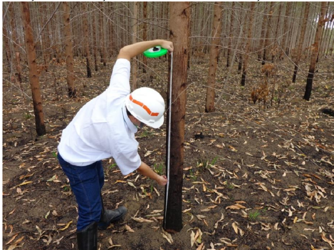
Figura 8 – Representação da medição da altura de carbonização
