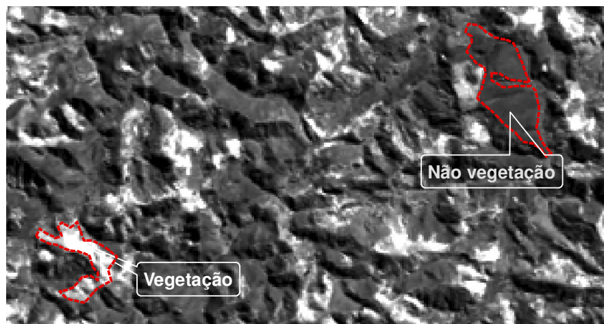
Figura 10 – Banda 4 da imagem MSS/LANDSAT de 1985 com filtro monocromático. As áreas claras representam locais com vegetação arbórea e áreas escuras as demais classes de uso do solo.
