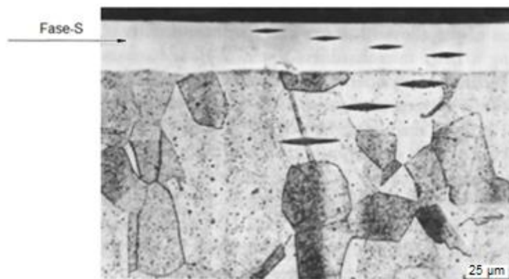
Figura 7 - Detalhe da camada de fase-S com microindentações e livre de precipitados. Fonte (SUN, LI e BELL, 1999c).
