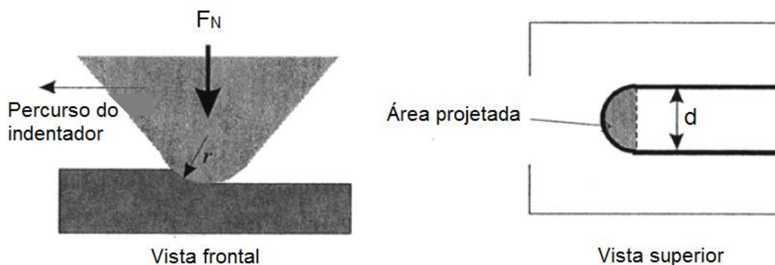
Figura 36 - Contato durante o ensaio de esclerometria. É feita a premissa de que o contato do indentador produz uma área projetada semicircular na amostra. Fonte: (ASTM G171, 2009).
