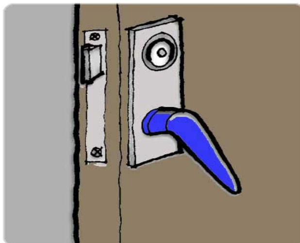
Figura 47. Porta da frente com vão igual ou maior que 80 cm livre e maçaneta do tipo alavanca
