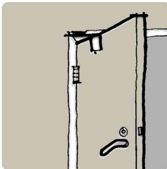
Figura 50. Molas aéreas ou dobradiças com molas que mantêm as portas fechadas
