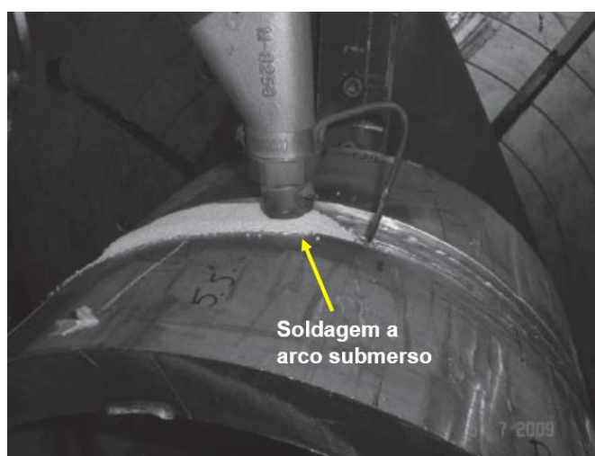
Figura 1 - Indicação em amarelo de soldagem a arco submerso em tubulação de aço inoxidável duplex UNS S31803. Fonte: adaptado de Pardal (2011).
