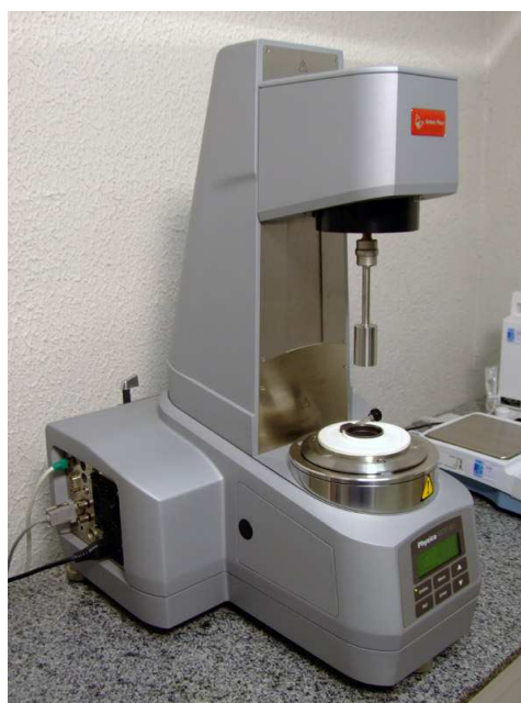
Figura 20 - Reômetro modelo MCR 501, fabricante Anton Paar
