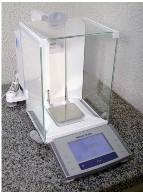
Figura 18 - Balança modelo XS204, fabricante Mettler Toledo
