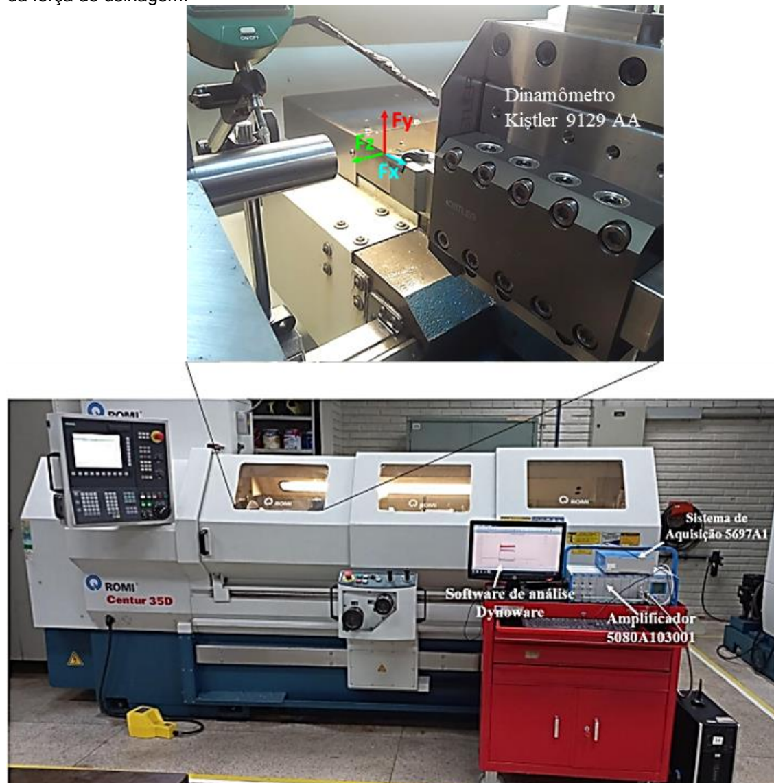
Figura 38 - Sistema dinâmométrico Kistler para o monitoramento das componentes ortogonais da força de usinagem.
