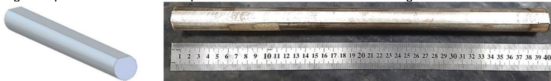
Figura 34 - Corpo de prova dos testes de pressão constante, à esquerda: configuração esquemática do corpo de prova para a operação de faceamento longitudinal da barra, e à direita: imagem representativa da barra após o fresamento de faceamento longitudinal.
