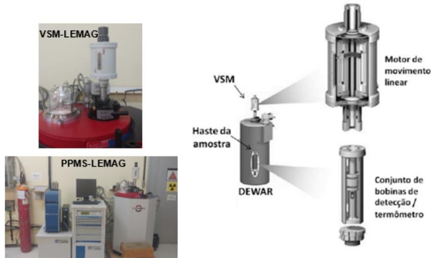
Figura 3.10: Fotos e diagramas esquemáticos do sistema PPMS-evercool-II instalado no LEMAG, contendo a opção VSM. Lado direito superior, esquema detalhado do motor do VSM, onde se acopla uma vareta que, por sua vez, tem na outra extremidade a amostra inserida no conjunto de bobinas de detecção (direito inferior).
