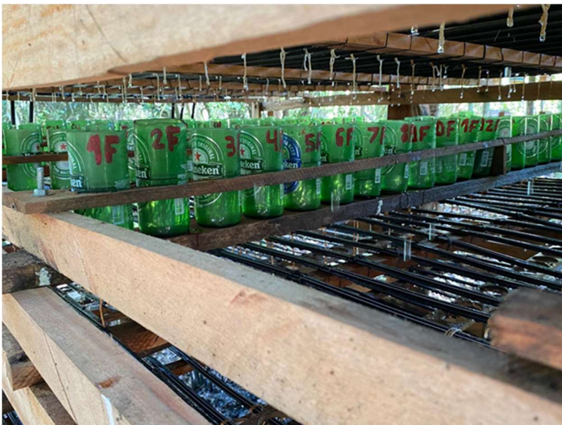
FIGURA 10. Procedimento de coleta de vazão dos gotejadores.
