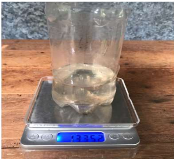
FIGURA 11. Método gravimétrico utilizado na avaliação de vazão.
