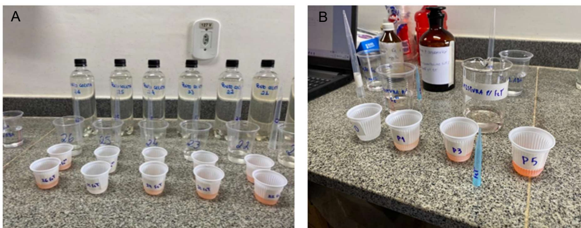
FIGURA 7. Realização das análises de laboratório. (a) preparo do padrão e das amostras, (b) colorimetria método Ferro GA.
