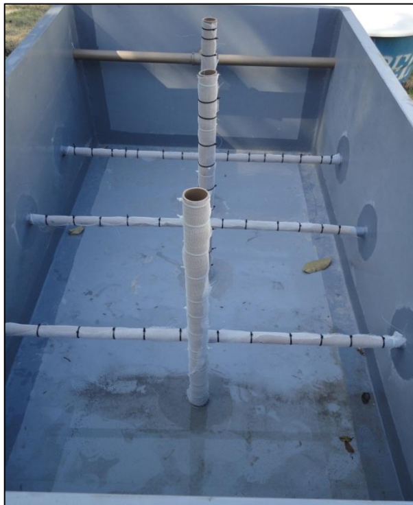
Figura 16. Malhas adicionadas às tubulações.
