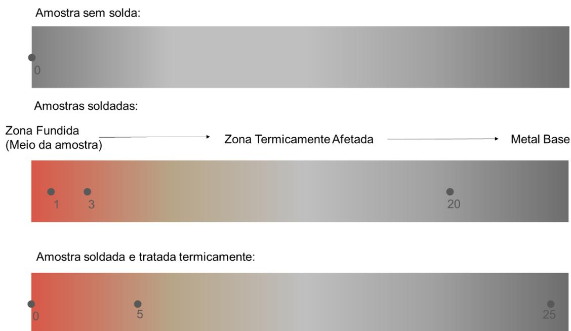
Figura 22 - Amostras submetidas ao ensaio de difusividade térmica e a localização dos pontos de aferição.
