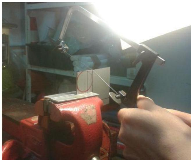
Figura 17 - Procedimento de corte para a preparação dos corpos de prova. Fonte: (Machado, 2015)
