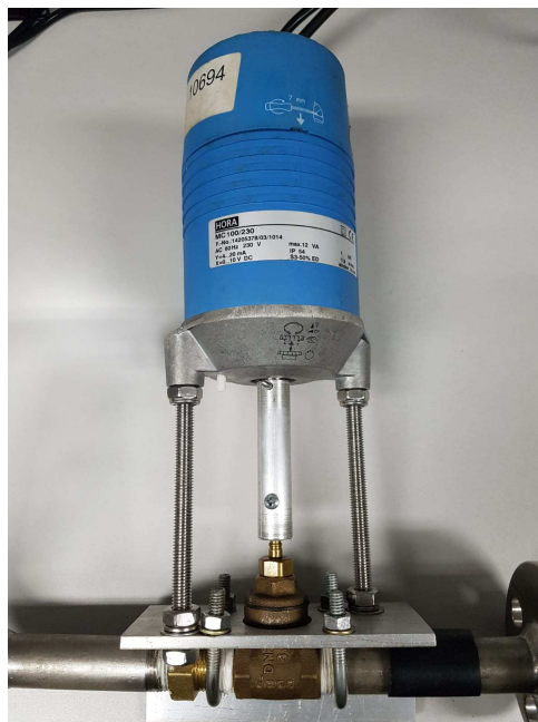
Figura 12 – Protótipo de ANM no circuito utilizando uma válvula gaveta e um atuador elétrico.
