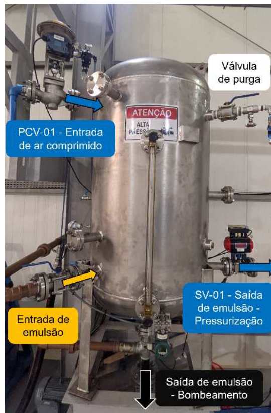
Figura 9 – Esquema de operação do vaso de pressão para realização do teste.
