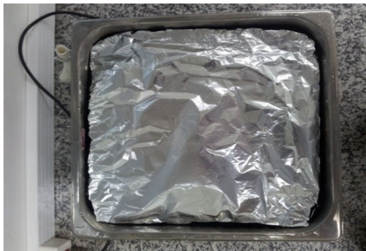
Figura 6. Teste da intensidade ultrassônica com papel alumínio dentro da cuba do banho de US.
