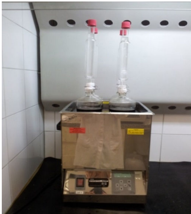
Figura 5. Sistema de US (banho de US modificado , frasco extrator e condensador de vapores) empregado para extração de sais em petróleos. Fonte: Laboratório de Caracterização e Processamento Primário de Petróleos – LabPetro UFES ( EM FASE DE PEDIDO DE DEPÓSITO DE PATENTE )
