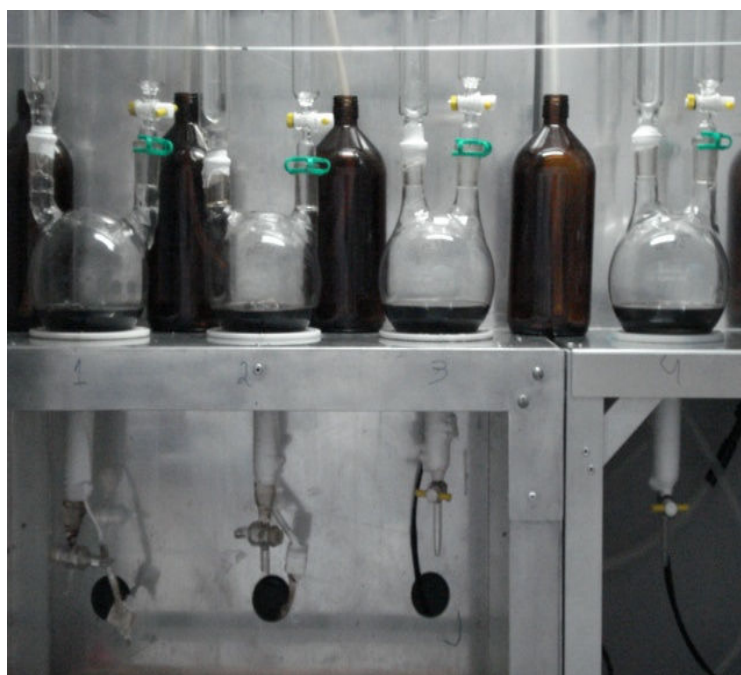
Figura 8. Sistema de extração de sais segundo a norma ASTM D6470 modificada por Morigaki et al. (2010) 18
