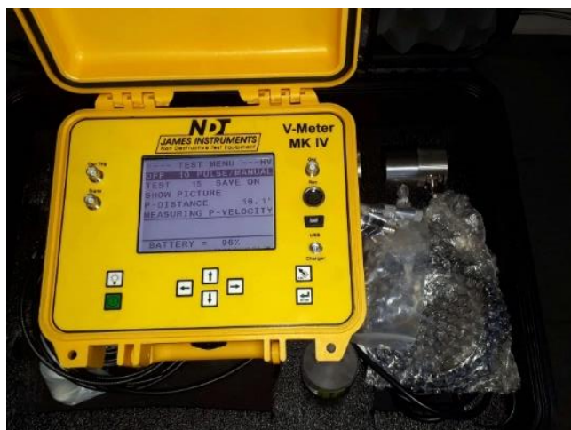
Figura 12: Aparelho de ultrassom utilizado nas medições em campo.
