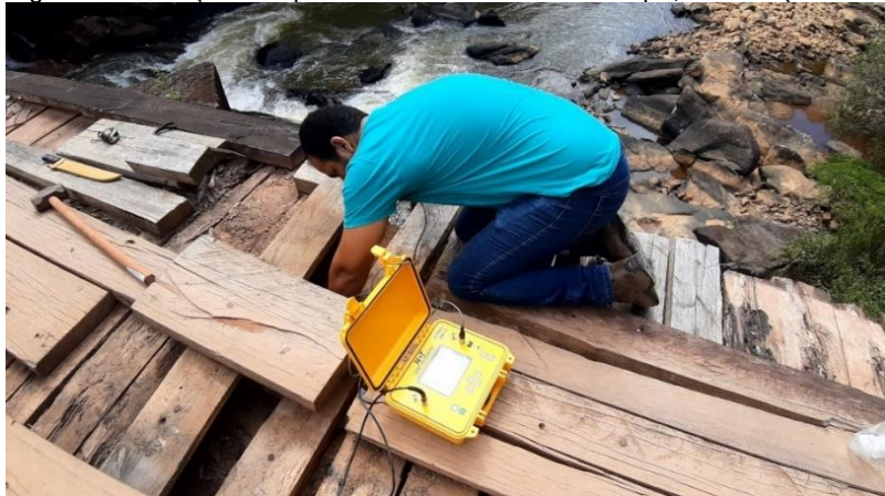
Figura 4. Utilização do aparelho de ultrassom em campo, modelo (V-Meter MK IV™ Ultrasonic System).
