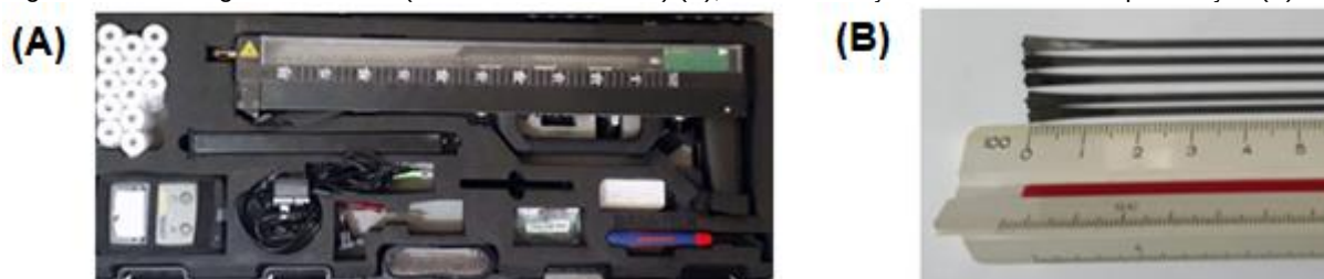
Figura 11: Resistógrafo R650-SC (Series 6, RINNTECH) (A); Hastes de aço utilizadas na microperfuração (B).
