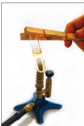
Figura 1.3 - Procedimento para aquecer líquidos em tubo de ensaio.
