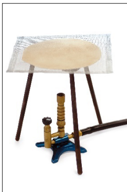
Figura 4.6 Sistema de aquecimento (tela de amianto + bico de Bunsen)
