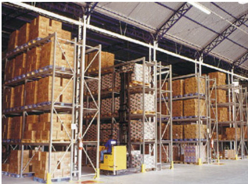
Figura 2.6 – Foto da movimentação de carga no sistema tipo porta-pallets , Altamira (2004).
