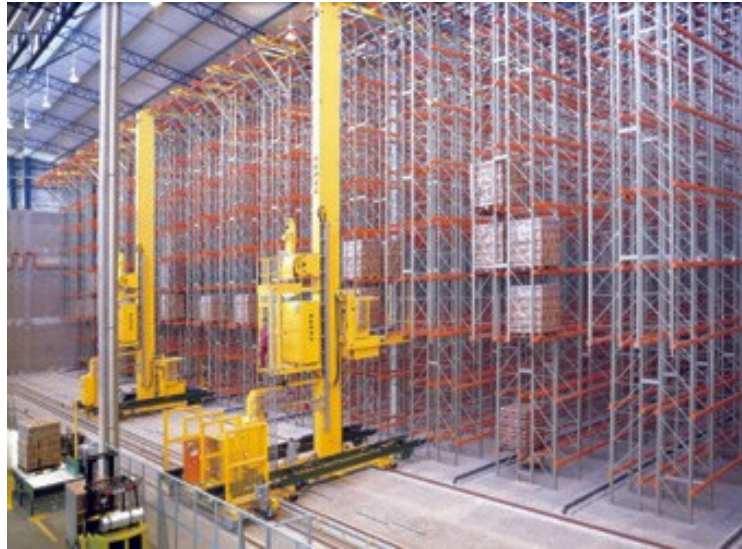
Figura 2.8 - Foto da movimentação de carga feita por meio de transelevadores no sistema porta-pallets autoportante , (Águia, 2005).
