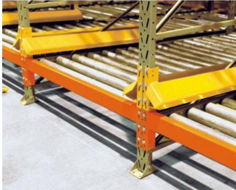
Figura 2.14 - Foto do conjunto de rolos utilizados na movimentação dos paletes no interior do sistema de armazenagem dinâmica, (Águia, 2005).
