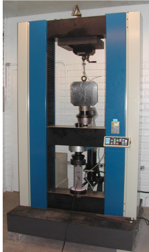
Figura 5.12 – Foto do equipamento utilizado na aplicação de carga.
