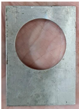
Figura 27. Porta-amostra vazado utilizado na análise de filmes por DRX.
