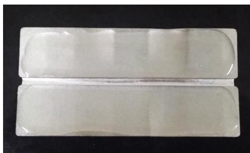
Figura 26. Filme formado sobre o pocket , após a evaporação dos solventes.
