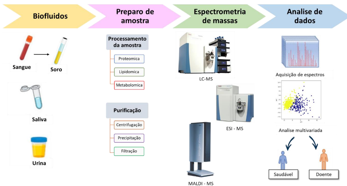
Figura1. 3. Diagrama de fluxo de trabalho para diagnósticos de doenças, detectando biomarcadores em biofluidos por MS.
