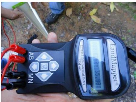
**Figura 3.** Medidor de condutividade elétrica portátil, modelo Landmapper ERM-02. Fonte: Os autores.
