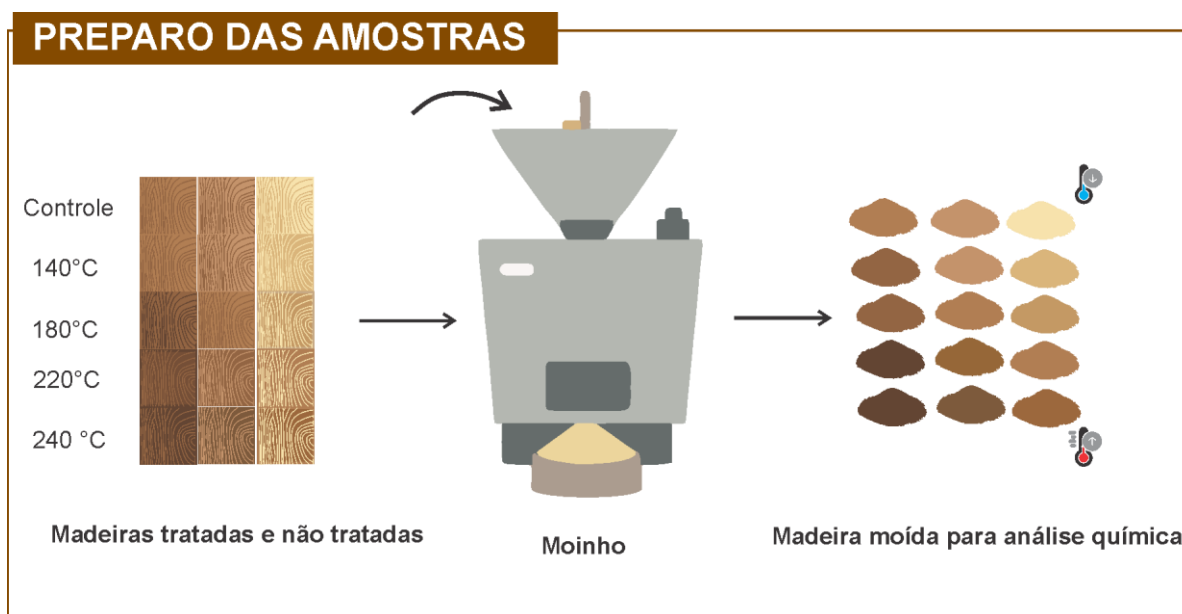
Figura 4 - Preparo das amostras de madeira para as análises químicas. Fonte: Próprio autor.
