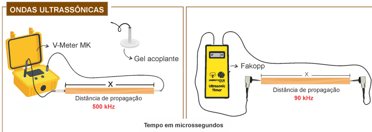
Figura 8 – Equipamentos V-Meter MK e UltraSonic Timer utilizados para caracterização não destrutiva de madeiras através do método direto. Fonte: próprio autor.
