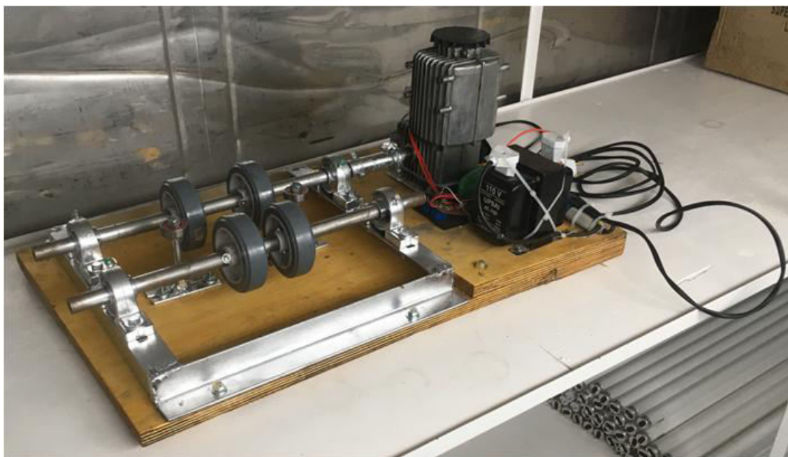
Figura 17: O rotor da cápsula de HHP. Na figura, o novo equipamento desenvolvido por Alvaro Luiz Santos, Alvaro Favarato Santos e Luiza Favarato Santos com o objetivo de girar a cápsula de Cu-Be contendo as células de levedura, para que estas não se depositem no fundo.
