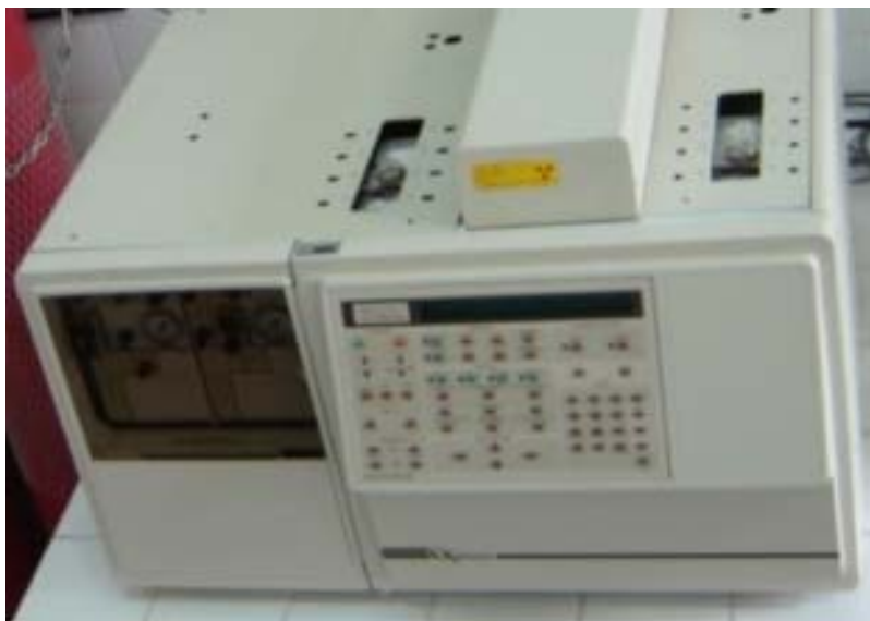
Figura 7. Cromatógrafo Gasoso (Varian, modelo Star 3600 CX).
