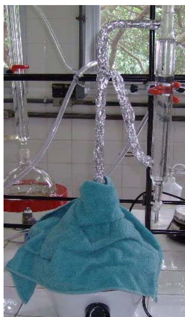
Figura 6. Sistema de hidrodestilação com aparelho de Clevenger modificado.
