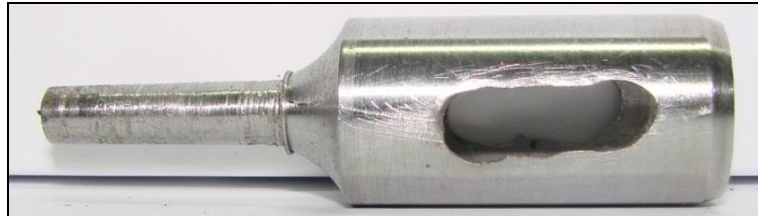
Figura 27: Ferramenta de corte com o prolongamento do rasgo, para facilitar a retirada do corpo de prova. Fonte: Pelo próprio autor, 2012.
