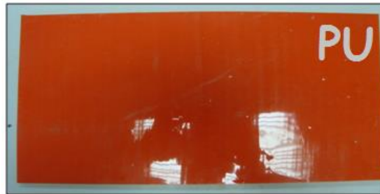
Figura 17: Superfície a ser ensaiada do material PU (brilhosa). Fonte: Pelo próprio autor, 2012.
