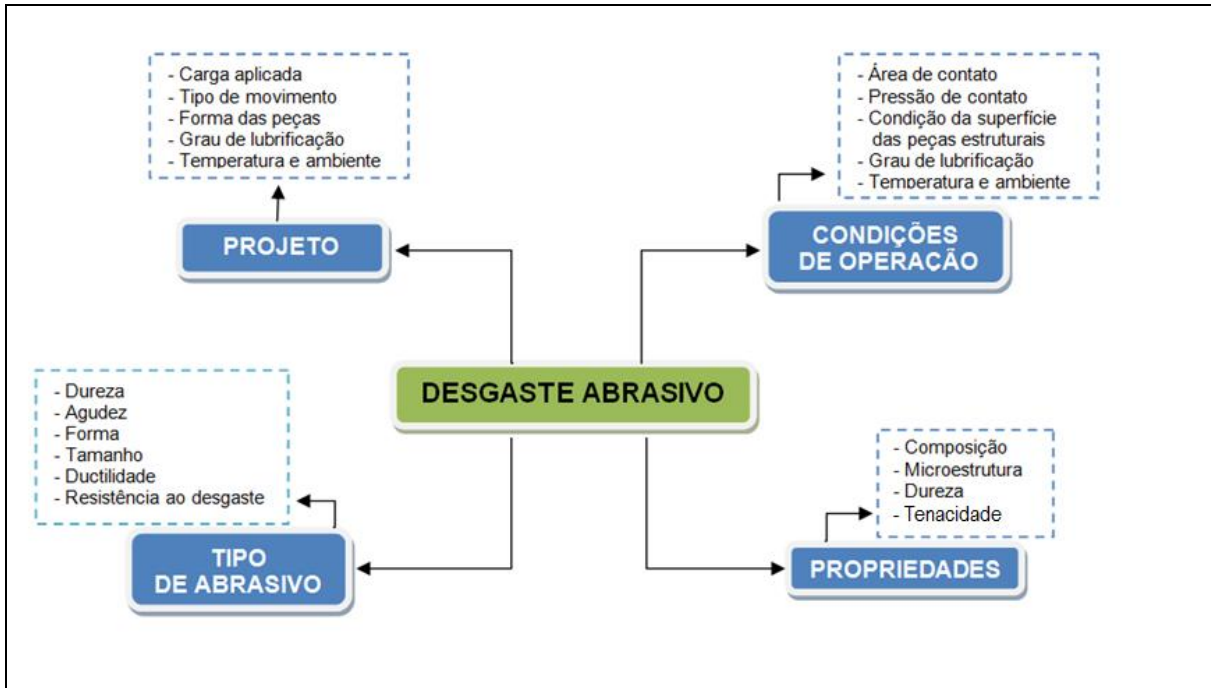
Figura 3: Parâmetros do desgaste abrasivo. Fonte: Pelo próprio autor, 2012.
