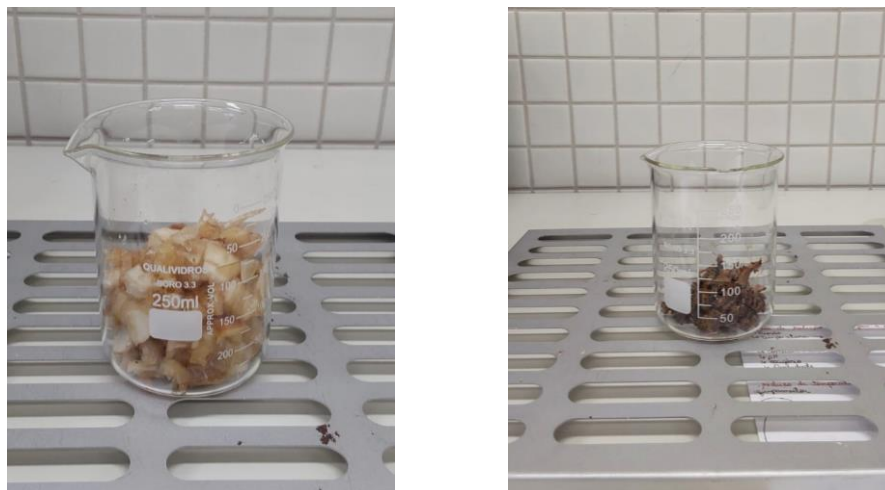
Figura 6 - PCB antes da secagem x PCB após a secagem.
