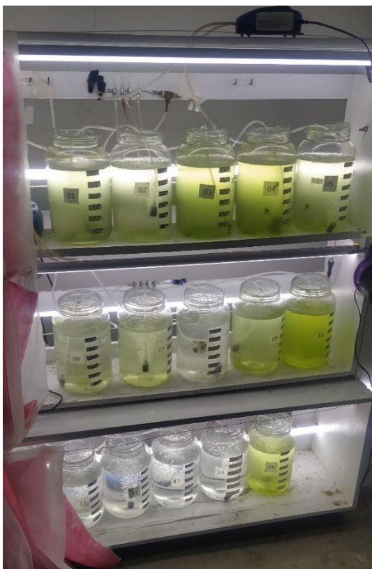
Figura 10 - Estante de cultivo de microalgas com cultivo em andamento.
